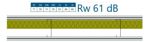
2.11 1x Drywall – Masonry – 2x Drywall – Green Glue
