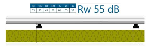
2.8 2x Drywall – MLV – Studs – 1x Drywall
